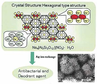
$Ag_{0,12}$  Na<sub>3.88</sub>[Al<sub>3</sub>Si<sub>3</sub>O<sub>12</sub>](NO<sub>3</sub>) H<sub>2</sub>O
